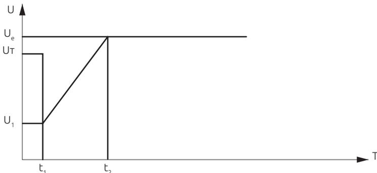
Рис. 6-5 Запуск по кратковременному импульсу + увеличение напряжения.
