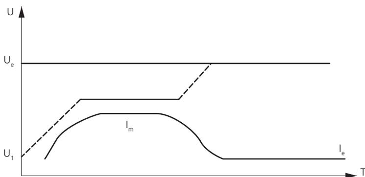
Рис. 6-3 График запуска по напряжению + ограничение тока.
