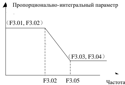
Рис. 6-7 Схема пропорционально-интегральных параметров контура скорости
