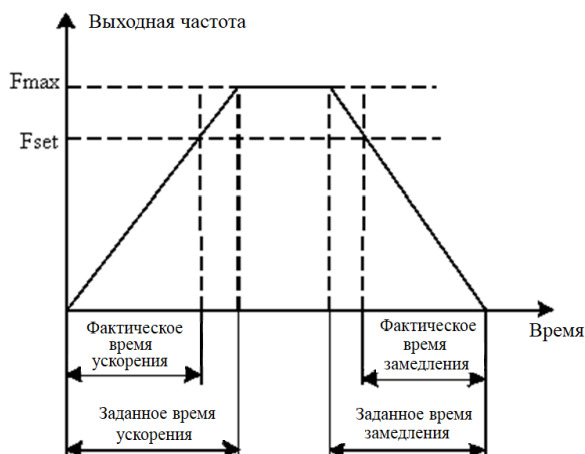
Рис. 6-2 Схема времени ускорения/замедления
