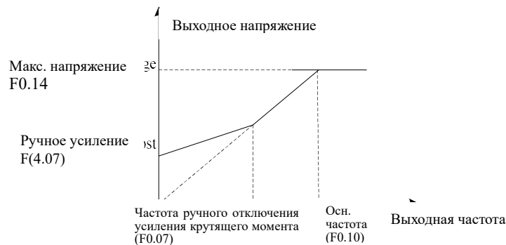
Рис.6-10 Схема усиления крутящего момента
