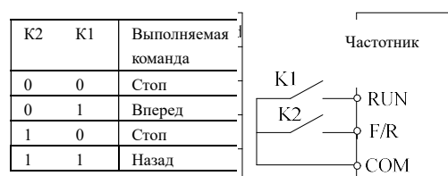
Рис. 6-14 Двухпроводной режим управления 2
