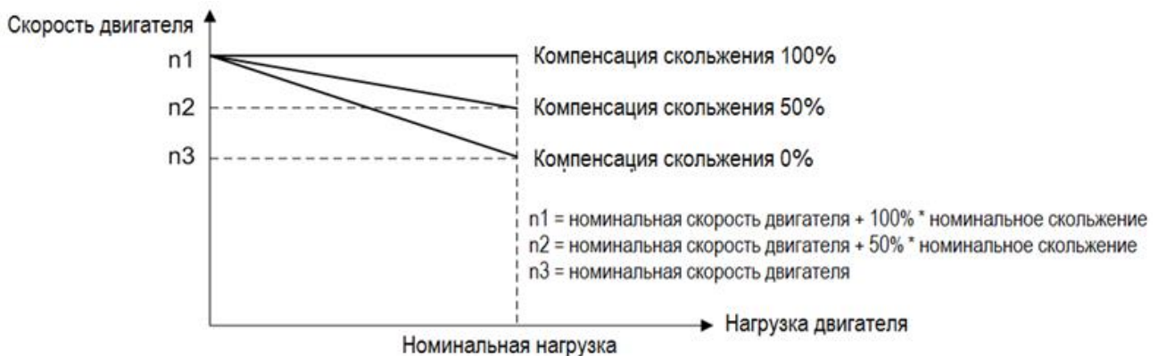
Компенсация скольжения в режиме вращения двигателя
