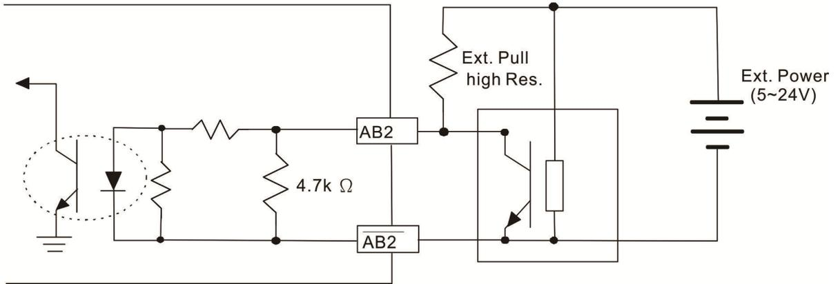
■ **EMC-PG01L/EMC-PG02L Wiring Diagram**
