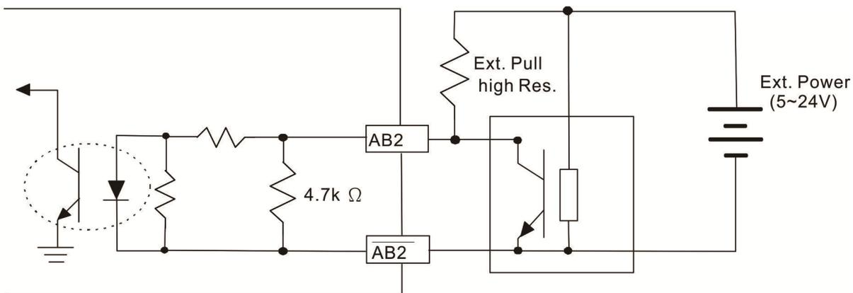
■ **EMC-PG010/EMC-PG020 Wiring Diagram**
