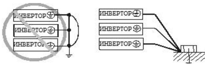
(2) Подключение силовых клемм
