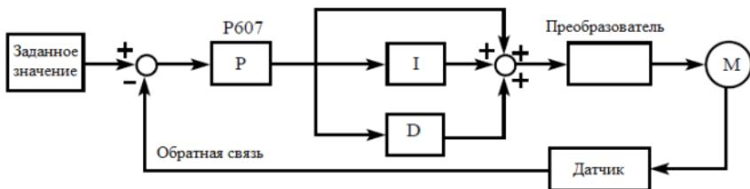
Замечания по использованию преобразователя в режиме PID-регулирования:
