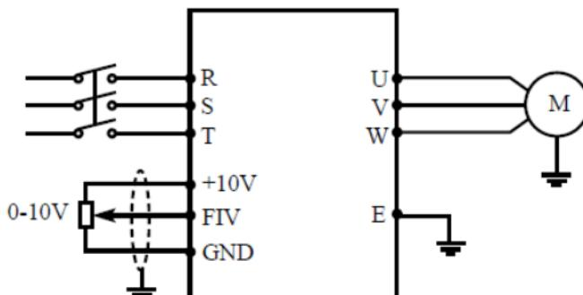
Примечание: сигнал напряжения FIV введен через внешний потенциометр (10 KΩ), чтобы управлять рабочей частотой преобразователя частоты.
