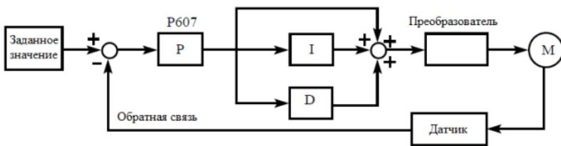
При использовании PI или PID – законов регулирования допускается возможность возникновения ошибки регулирования с величиной до  $\pm 10\%$  от значения максимального сигнала обратной связи. Допустимая ошибка определяется величиной параметра Р620.
