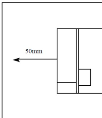
**Установка нескольких преобразователей частоты в одном шкафе:**
