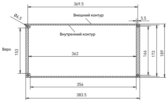
Рис. 3.5: Размеры выреза для фланцевого крепления приводов типоразмеров M14 (единица: мм)
