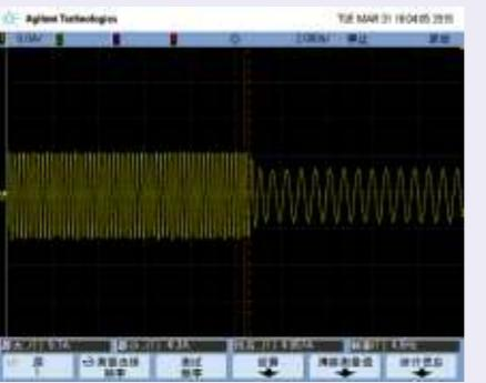
Форма тока при внезапной разгрузке в режиме векторного управления с полной нагрузкой на частоте 0,5 Гц.
