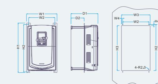
Фланцевый монтаж преобразователей 37 ~ 110кВт
