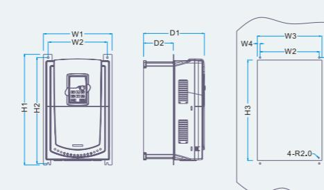
Фланцевый монтаж преобразователей 37 ~ 110кВт
