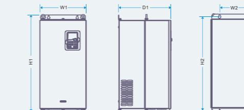
Фланцевый монтаж преобразователей 132 ~ 200кВт
