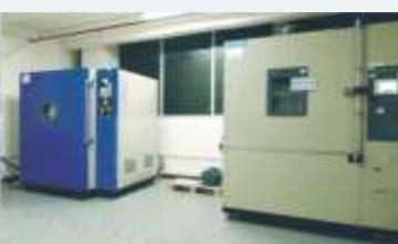
Камера испытаний на воздействие низкого давления (слева)
