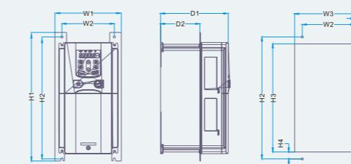
Фланцевый монтаж преобразователей 18,5 ~ 30кВт
