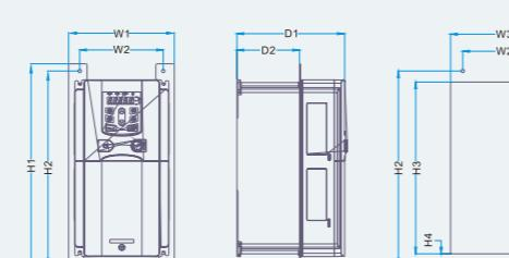
Фланцевый монтаж преобразователей 11 ~ 15кВт
