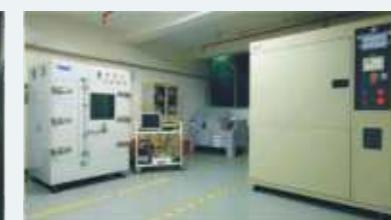
Камера испытаний на естественную конвекцию (слева)
