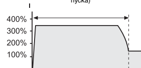
Защита от чрезмерной длительности пуска (2 - 20 секунд), Off (Выключено) - нет защиты от чрезмерной длительности пуска
