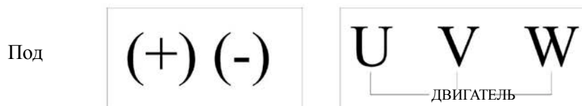
Обозначение контакта трехфазной основной цепи 185~315 кВт (свыше 160 кВт встроенный фильтр пост. тока)
